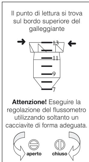
Il flussometro è un misuratore di portata dotato di un regolatore di portata incorporato. Il campo di indicazione è compreso tra  $1 \div 13$  l/min,  $8 \div 30$  l/min e  $5 \div 40$  l/min a seconda delle versioni.
